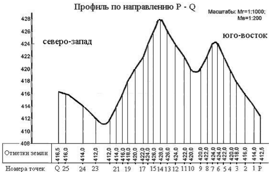
Рис 2. Построение профиля по линии РQ
