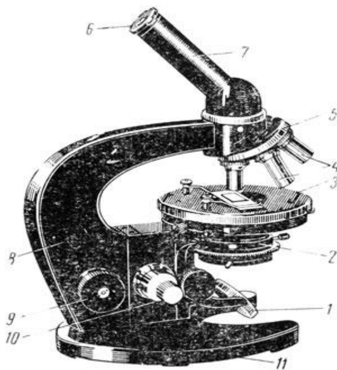
Рис. 1. Микроскоп МБИ-1: 1 - зеркало, 2 - конденсор, 3 - предметный столик, 4 - объективы, 5 - револьвер, 6 - окуляр, 7 - тубус, 8 - тубусодержатель, 9 - макрометрический винт, 10 - микрометрический винт, 11 - ножка
